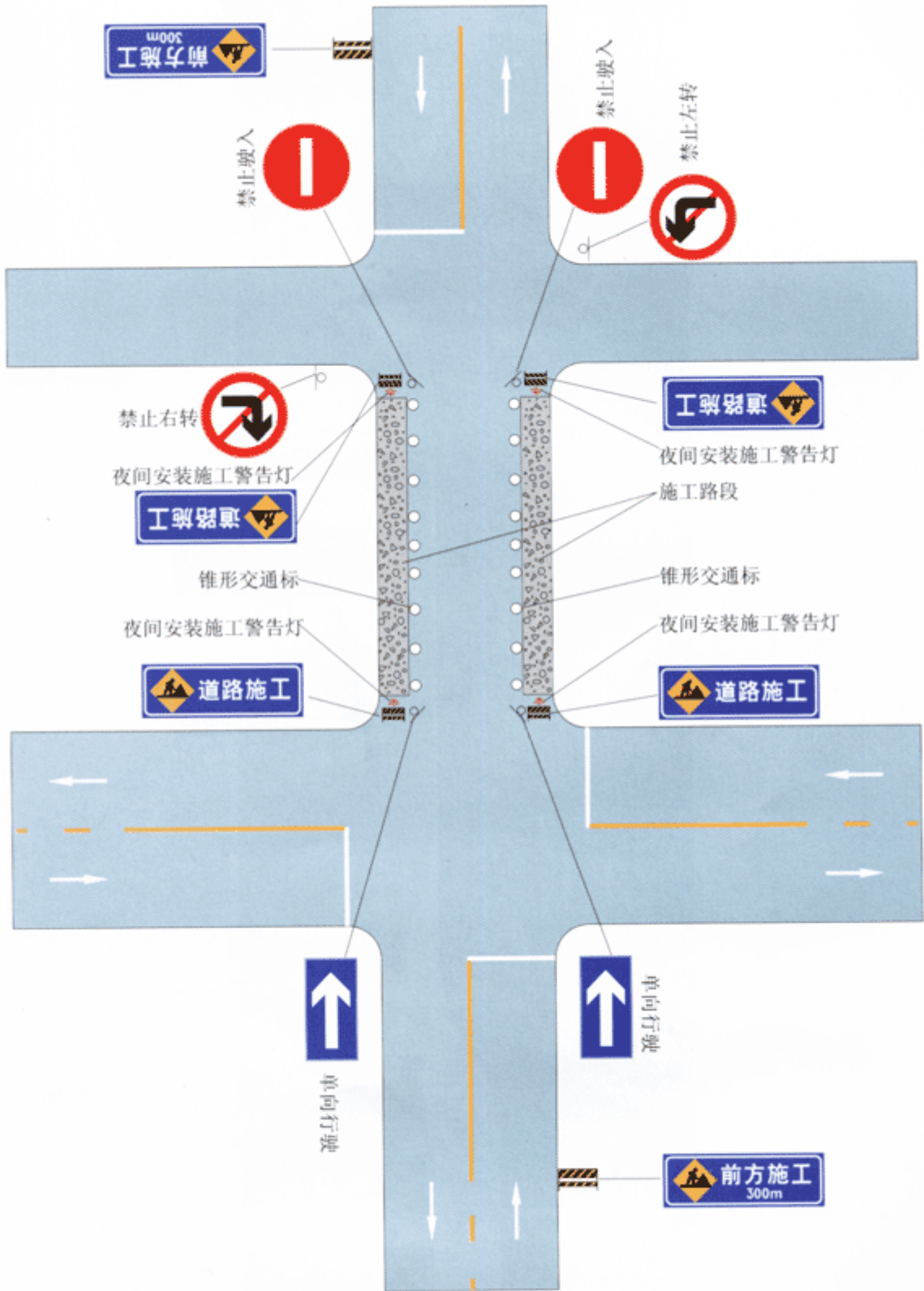
图 J11 市区道路两侧施工只能单向行驶时的设施布设例
