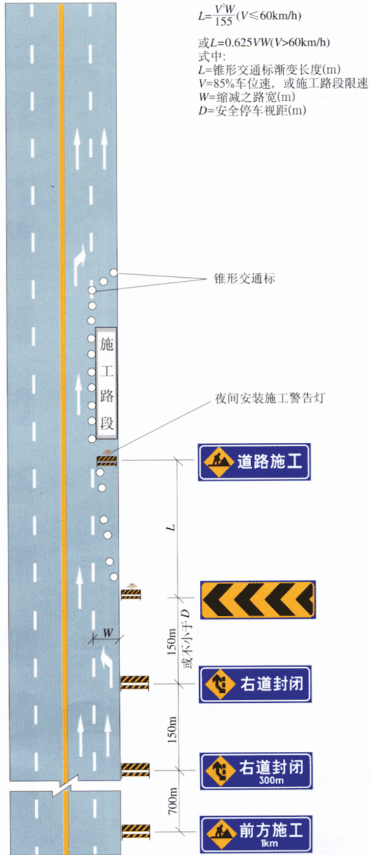
图 J5 同向车道中有一条车道路面施工时设施布设例
