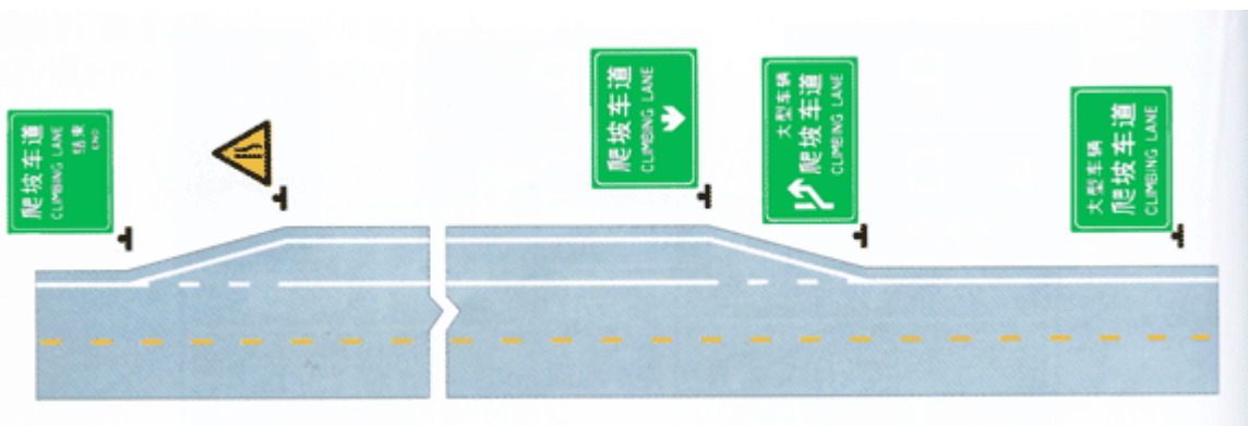
图 9 爬坡车道标志设置例
