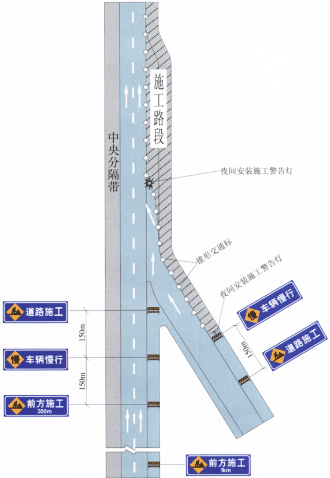
图 J14 高速公路入口加速车道边缘施工时的设施布设例
