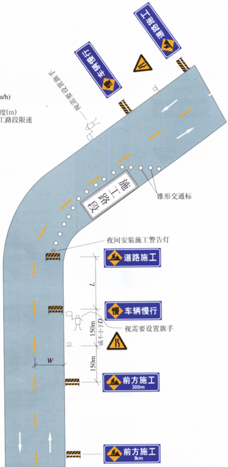
图 J2 视距不良双车道路面局部施工时设施布设例
