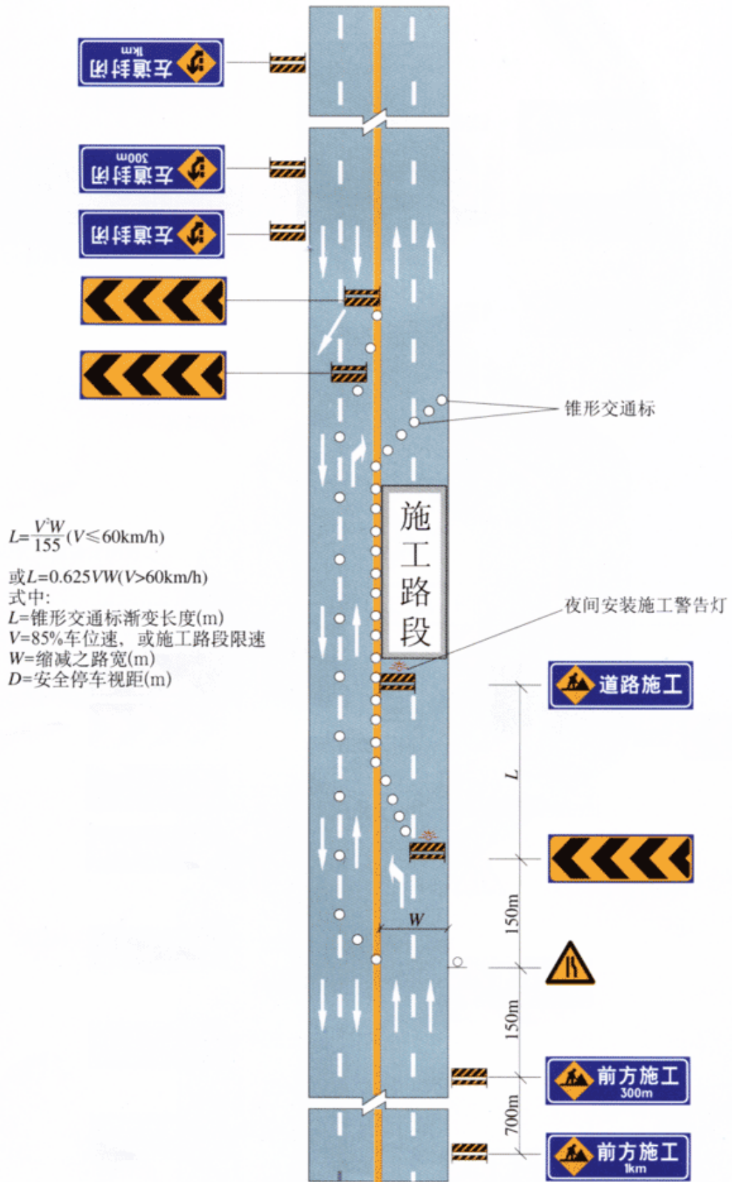
图 J4 四车道以上道路一侧路面施工时设施布设例
