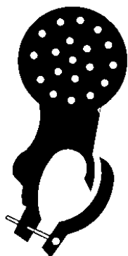
图 26 固定于缆索护栏的轮廓标
